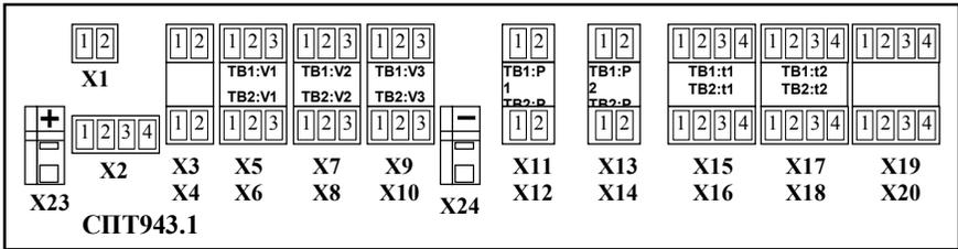
Рисунок 9.1 – Размещение гнезд для подключения внешних цепей
