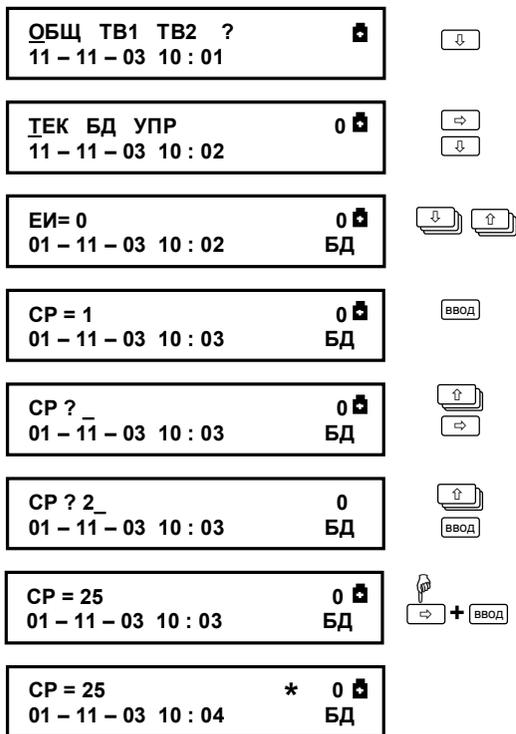
Рисунок 5.5 – Ввод числового значения параметра СР=25 и установка признака "оперативный параметр"
