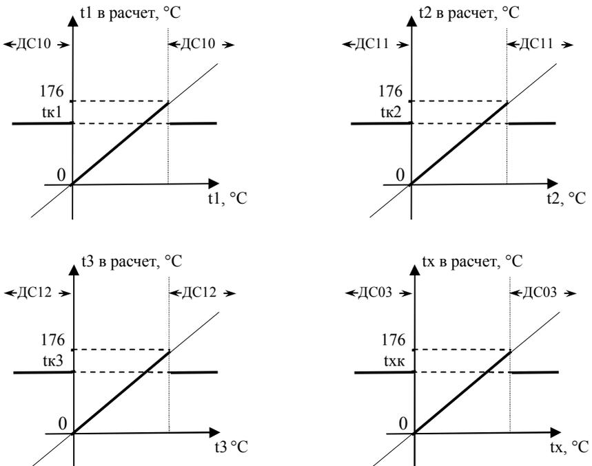
Рисунок 6.3 – Контроль температуры и использование констант
