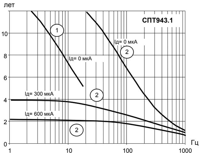
Рисунок 2.1 Зависимость ресурса батареи (лет) от частоты входных импульсов (Гц) и суммарного среднего тока потребления преобразователей объема  $I_d$ . ① – датчики с низкочастотным сигналом, ② – датчики с высокочастотным сигналом.
