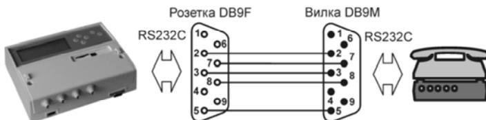
**Примечание** Для нормальной работы интерфейса RS232C напряжение между контактами RTS и GND должно быть в пределах +5,5...12В.
