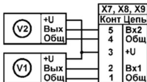
Рис. 4.3 Подключение УЗ счетчиков с питанием от тепловычислителя
