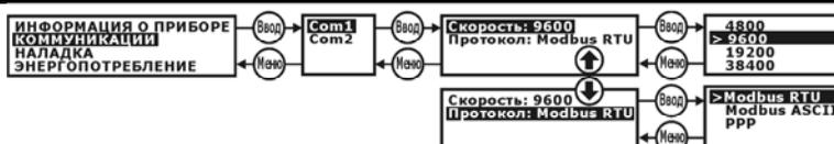
Рис. 3.10 – Настройка Com-портов
