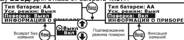
Рис. 3.13 – Включение режима проверки
