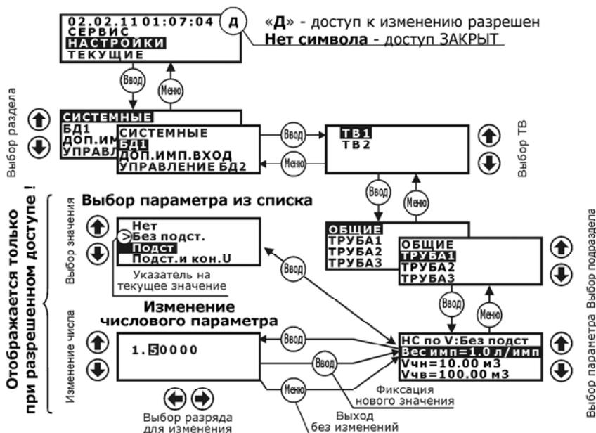
Рис. 3.1 – Пример просмотра значения параметра настройки
