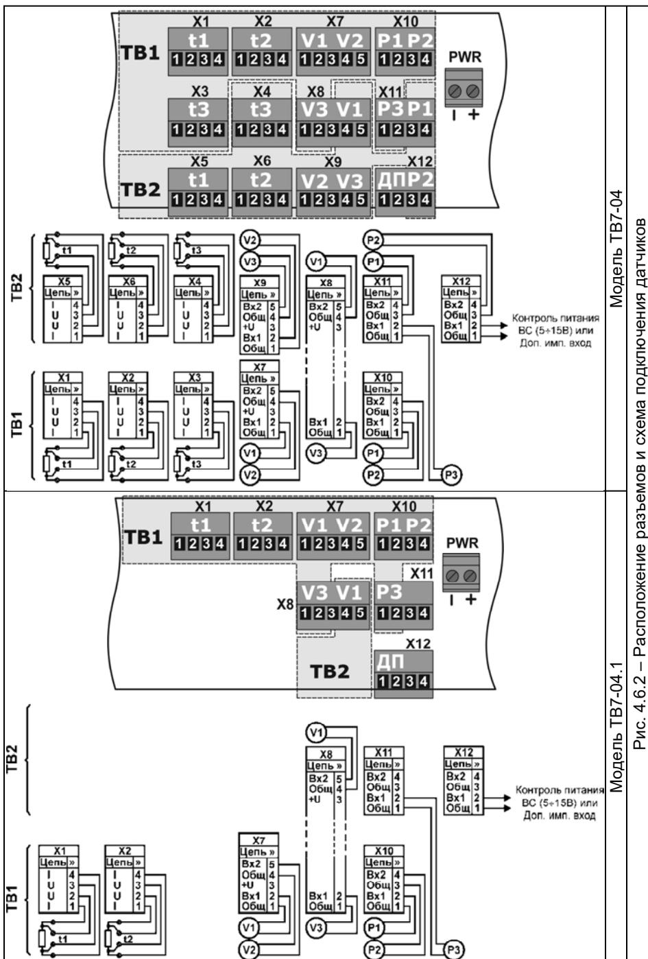
Рис. 4.6.2 – Расположение разъемов и схема подключения датчиков
