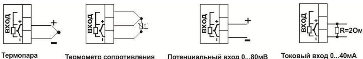
Рисунок 6 – Схемы подключения датчиков
