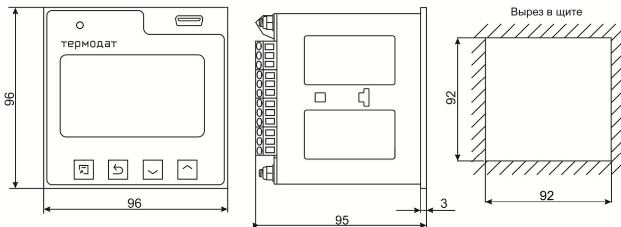
**Рисунок 12 – Габаритные размеры основного блока прибора Термодат-25Е6/...../F**
