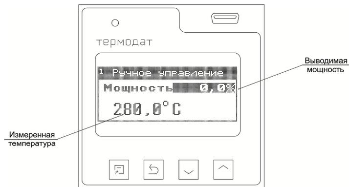
Рисунок 5. Режим индикации «Ручное управление»
