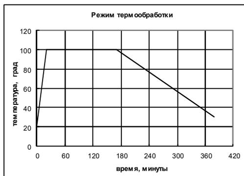
**Рисунок 5 –График режима термообработки**
