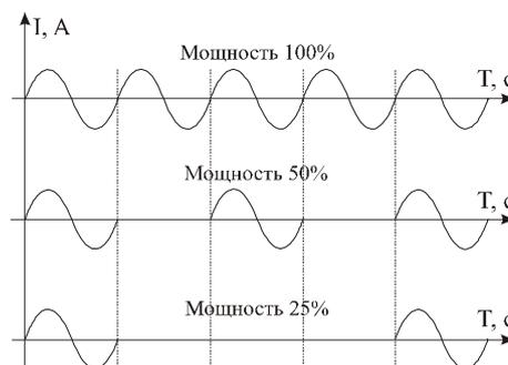
При ПИД регулировании мощность задается в процентах, при двухпозиционном регулировании нагреватель либо включен, либо выключен (да/нет).
