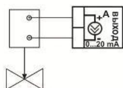
Подключение задвижки с электроприводом
