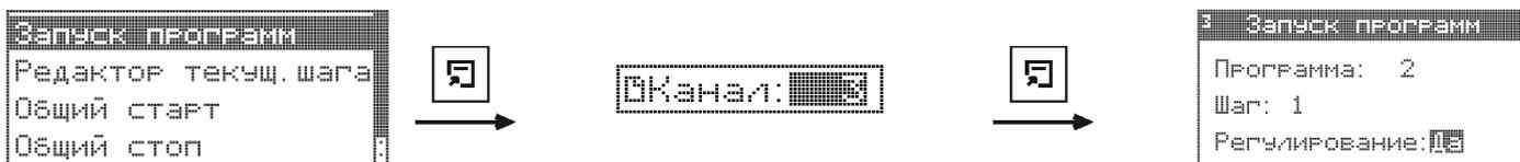
**Рисунок 3. Режим индикации «Регулирование по программе»**
