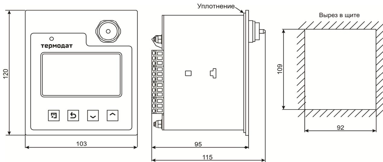
**Рисунок 13 – Габаритные размеры основного блока прибора Термодат-25Е6/...../F/IP67**
