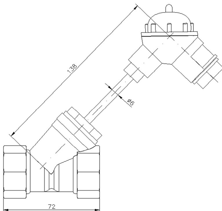
Корпус выполнен из нержавеющей стали 12Х18Н10Т и снабжен неподвижным штуцером М30х1,5 для монтажа в фильтр DN25.
