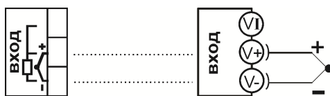
Рис 4 Схема подключения термопары к входу прибора.
