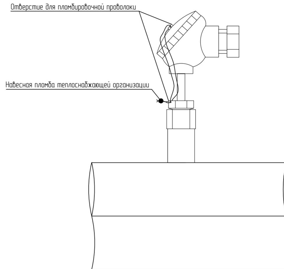
При допуске в эксплуатацию приборов коммерческого учета тепловой энергии и теплоносителя тепловычислитель ТМК-Н, преобразователи расхода электромагнитные МастерФлоу, термопреобразователи КТСП-Н должны быть опломбированы представителем теплоснабжающей организации согласно приведенной схеме.
