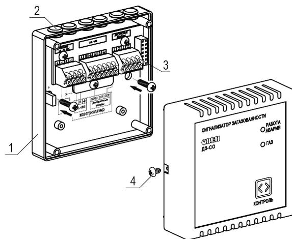
1 – основание; 2 – заглушки кабельных вводов; 3 – клеммники; 4 – блокировочный винт
