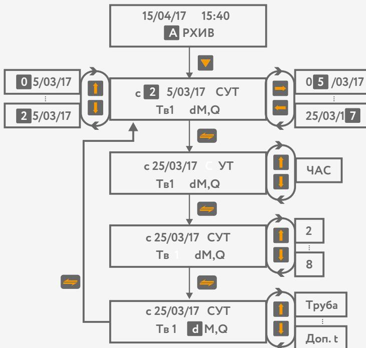
Рисунок 20 – Просмотр архивной информации по тепловому вводу
