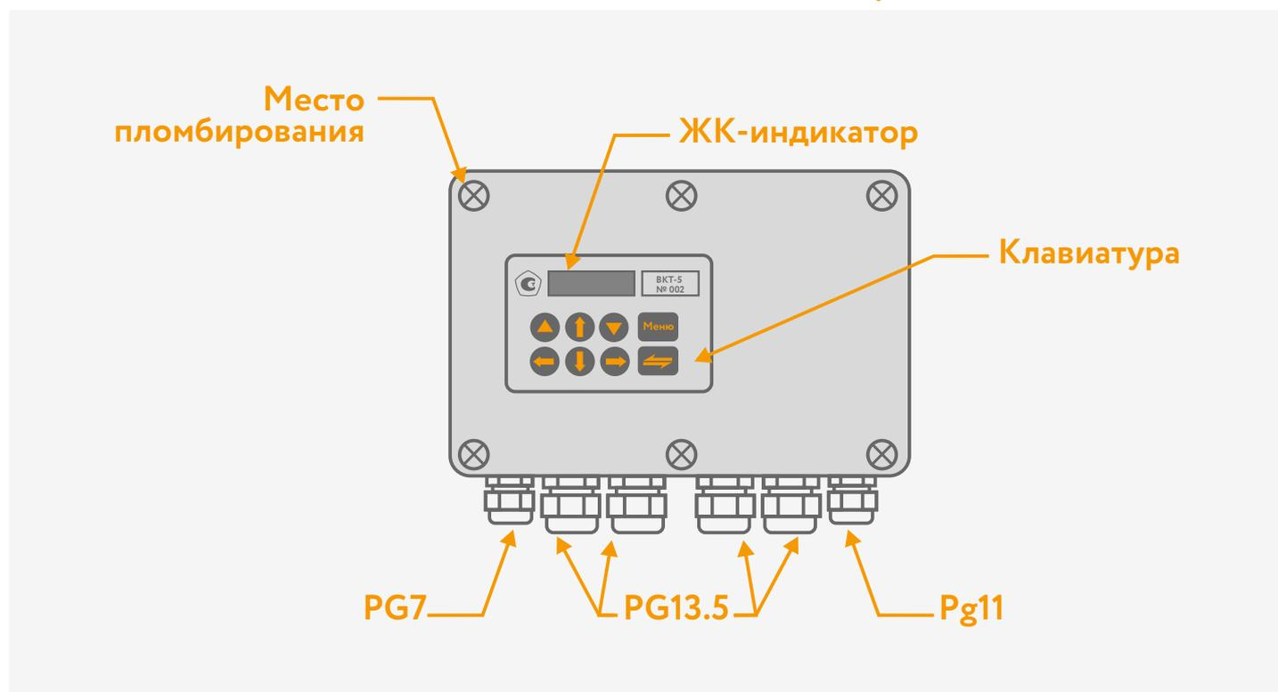
Внутри корпуса расположены плата микропроцессора с ЖК-дисплеем (верхняя часть корпуса), доступ к которой ограничивается защитным шильдиком, и плата клеммников (нижняя часть корпуса). Плата процессора опломбирована поверителем.
