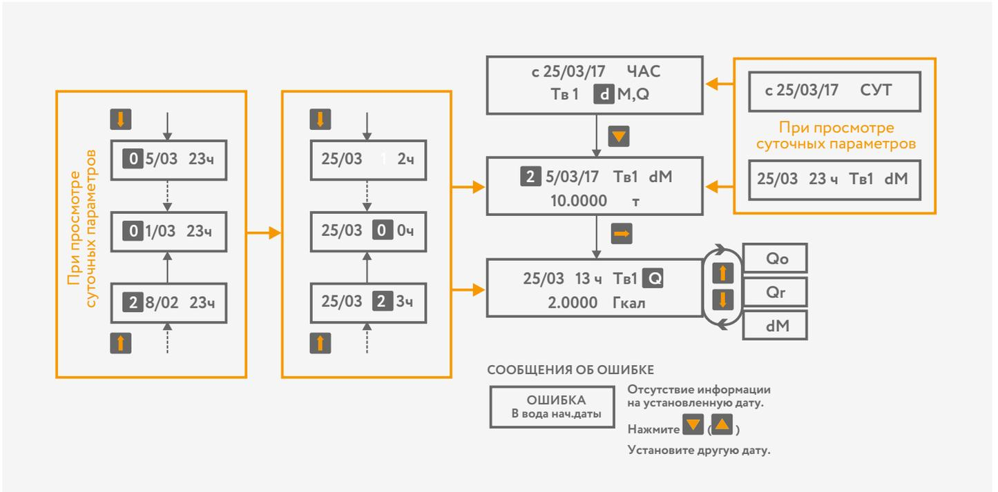
Рисунок 21 – Просмотр архивной информации по трубопроводу
