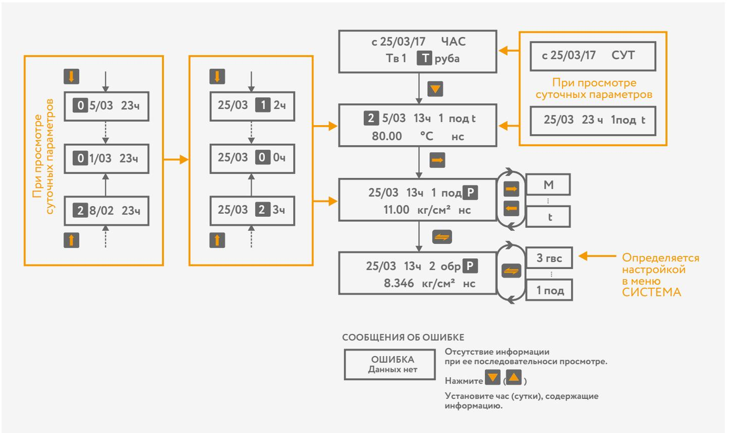
Рисунок 22 – Просмотр архивной информации по температуре среды
