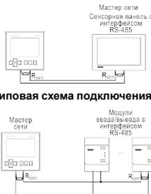
Рисунок 12 – Типовая схема подключения в режиме Slave
