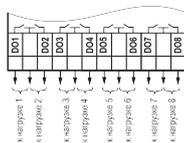
Рисунок 8 – Схема подключения к выходам типа «P»
